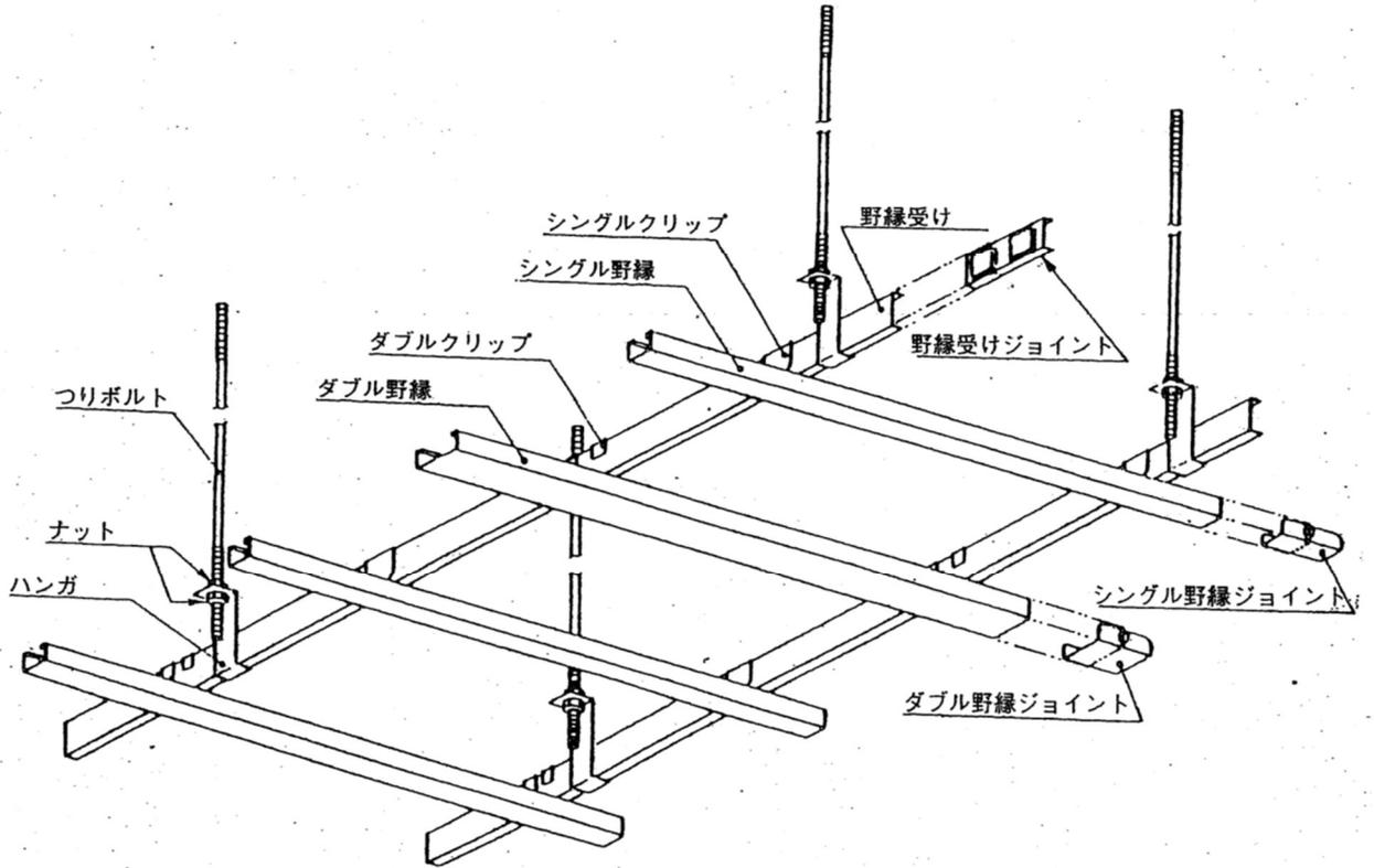
床下地材、壁下地材、天井下地材に分けられますが、ここでは天井下地材について述べます。
